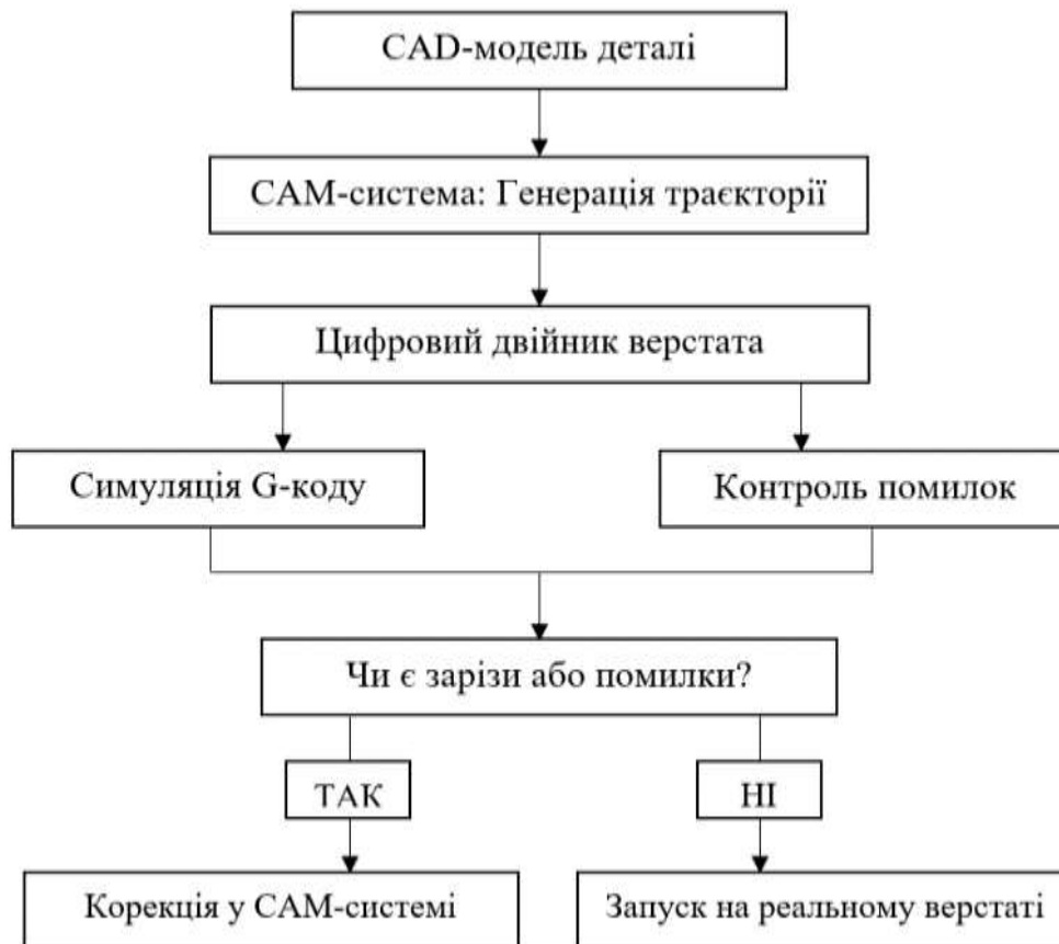
Рис. 1. Схема функціонування цифрового двійника при перевірці керуючих програм
