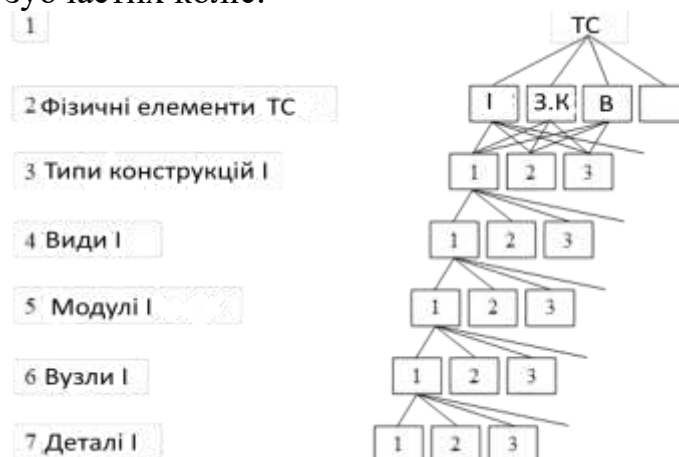
Рис. 1. Технологічна система у вигляді ієрархічного графа (I– інструмент; З.К – зубчасте колесо; В – верстат.)
