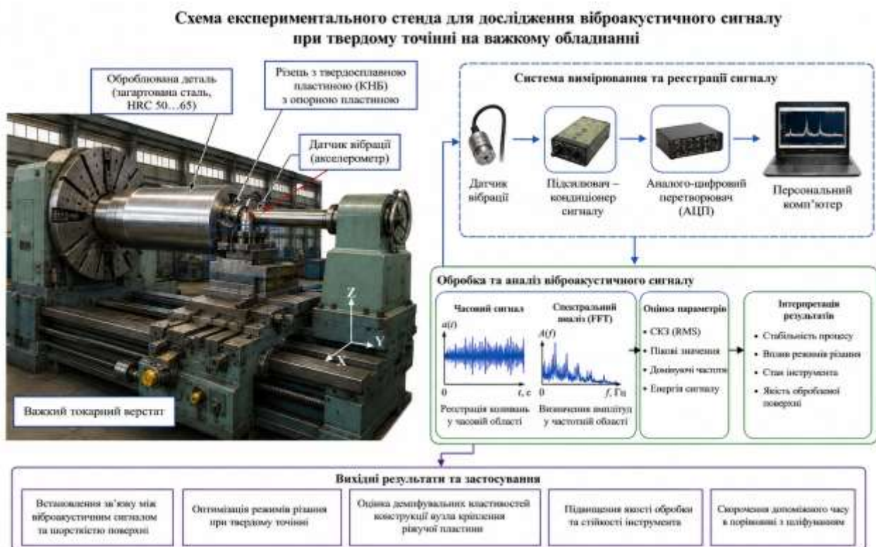
Рис. 1. Схема експериментального стенда для дослідження віброакустичного сигналу при твердому точінні на важкому обладнанні
