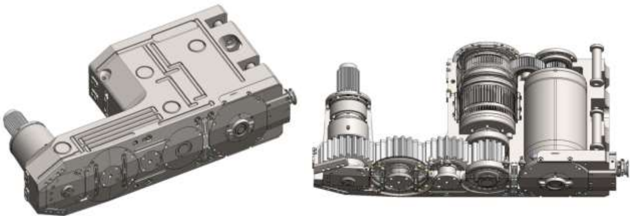
Рис. 3 Ріжуча частина очисного комбайна УКД200-500
