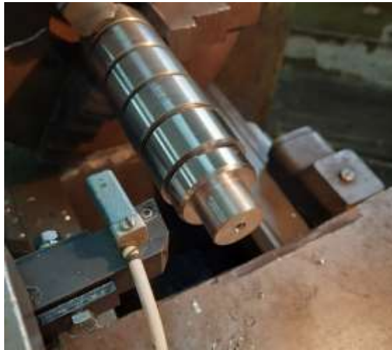
Рис. 2. Експериментальні дослідження демпфувальної здатності різця із демпером сухого тертя
